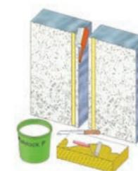
4. Na jednu stranu steny naneste na povrch inštalovanej minerálnej vlny vrstvu Polylack Elastic v hrúbke  $1$  mm a zabezpečte pokračovanie náteru v šírke  $2$  cm na oboch okrajoch medzery na jednej strane steny.
