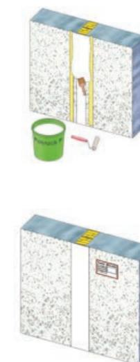
Protipožiarne tesnenie stavebných škár / Fire stop sealing of architectural joints
