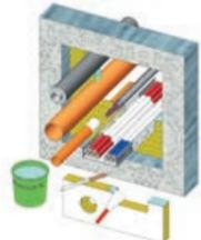
6. Potrubia vyrobené z horľavých materiálov do priemeru 50 mm môžu byť tiež utesnené tmelom Polylack KG. V tomto prípade musí byť výplň prispôbená priemeru rúry. Hĺbka výplne je vždy 25 mm, jej šírka sa rovná polomeru rúry.
